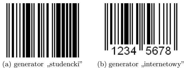
Ryc. 1: Wyniki kodowania sekwencji 12345678 w EAN-8
