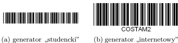
Ryc. 3: Wyniki kodowania sekwencji COSTAM2 w CODE-39
