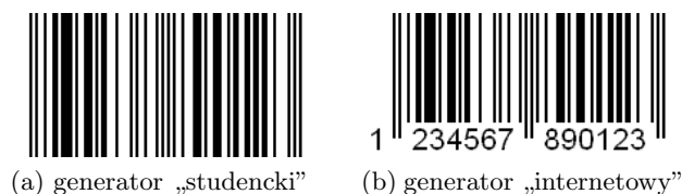
Ryc. 2: Wyniki kodowania sekwencji 1234567890123 w EAN-13
